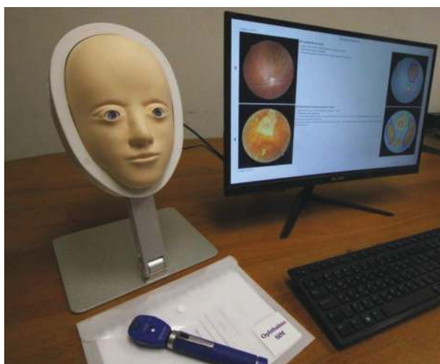
Рис. 1. Общий вид аппаратно-программного симулятора офтальмоскопии
