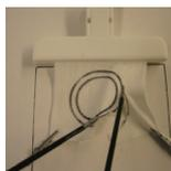
За минимальное время необходимо иссечь ножницами Метценбаум круг в промежутке между двумя маркированными окружностями. Диссектором Мэриленд в другой руке обеспечивается натяжение салфетки и оптимальная тракция / угол к ножницам. Возможные ошибки: повреждение маркировочной линии; чрезмерная тракция, повлекшая выскальзывание салфетки из фиксатора.
