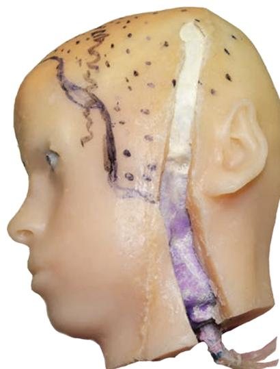
Рис. 2. Силиконовый функциональный прототип головы пациента с гидроцефалией
