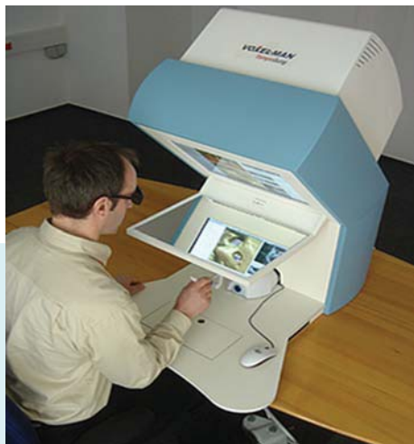
Рис. 1. Симулятор ВокселМан: эффект виртуальной 3D-реальности создается при помощи 3D-очков и зеркального отображения экрана компьютера, позволяя пользователю осуществлять операции с виртуальным объектом под зеркальной плоскостью.
