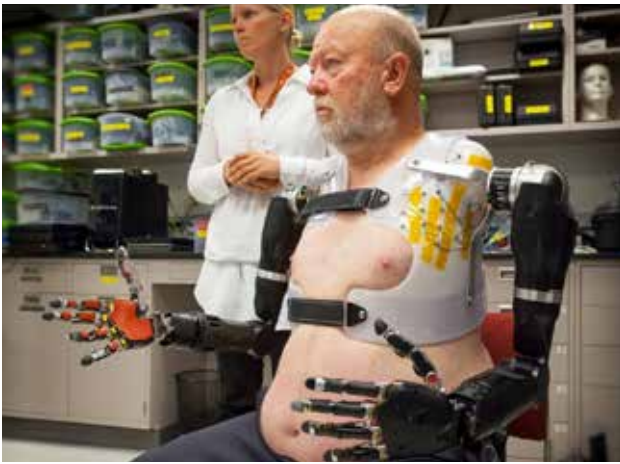
Бионический протез, движущийся «силой мысли», 2015 г. Лаборатория прикладной физики Университета Джона Хопкинса
