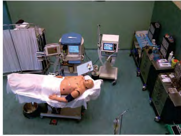
Зал отработки клинических сценариев оснащен роботом пациента ХПС высшего класса реалистичности с физиологией пациента, распознаванием вводимых лекарств и газообменом
